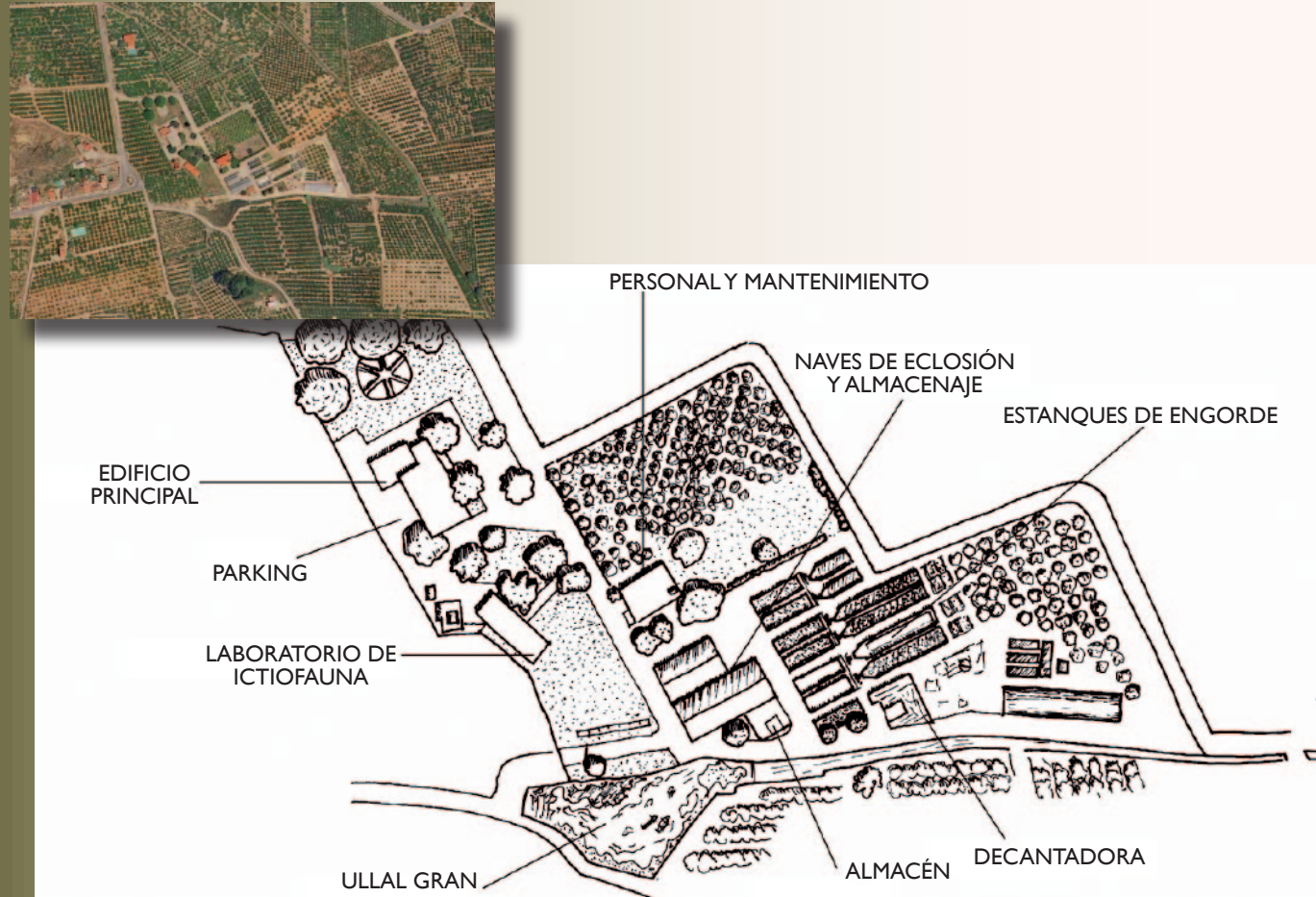
Figura 13.2: Esquema de planta y composición de las IAC de Polinyà del Xúquer. Vista aérea del entorno agrícola y urbano de las IAC
