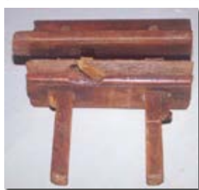
Algunas herramientas de carpintero de ribera: arriba, “garlopa”, abajo, “azueta”, “acanalador” y “bramil” (Fotos: Colección Municipal de Etnografía de Alicante. Museo Nueva Tabarca).
