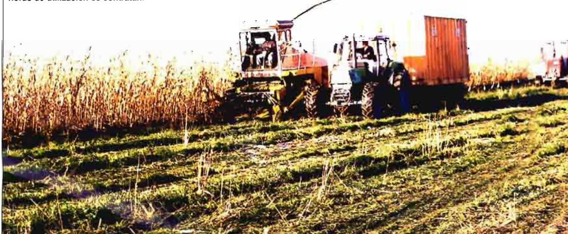
Equipo de picado de maíz para ensilado. Estos equipos de alto coste y pocas horas de utilización se contratan.
