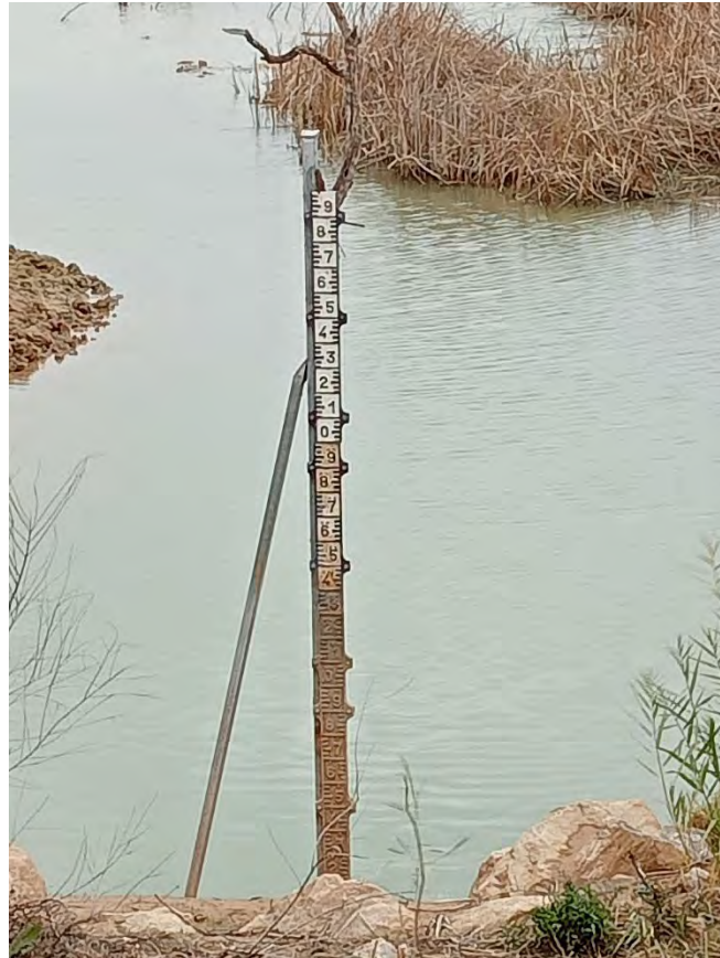
Ilustración 43. Mira topográfica clavada en la Laguna de Las Cañas, haciendo de limnómetro
