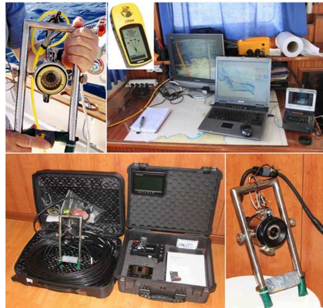
Figura 2. Material empleado para la toma de muestras. (a) primera cámara submarina Mariscope utilizada; (b) el ordenador portátil, la grabadora, la pantalla de televisión para la visualización de las imágenes y el GPS Garmin, en la esquina superior izquierda; (c) equipo completo Deep Blue Pro , que incluye la cámara submarina, el cable umbilical, un monitor LCD de 8" y un grabador DVD; (d) cámara Deep Blue Pro .
