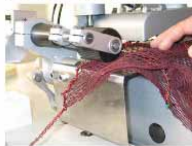
Prensatelas y rodillo de arrastre de paño o "puller" (izquierda), detalle del prensatelas (dcha. arriba) y detalle del rodillo (dcha. abajo) / Estudio Valoración técnica de la mecanización del montaje y reparación de redes de cerco. Azti-Tecnalia, 2006.
