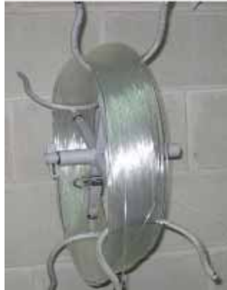
Imagen Debandoira: dispositivo giratorio en el que se coloca la madeja de hilo para "debandarla" (desunirla o esparcirla). ©
