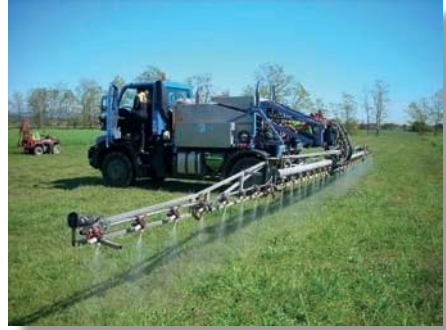
Situación óptima, sin impacto directo del líquido pulverizado sobre elementos de la barra
