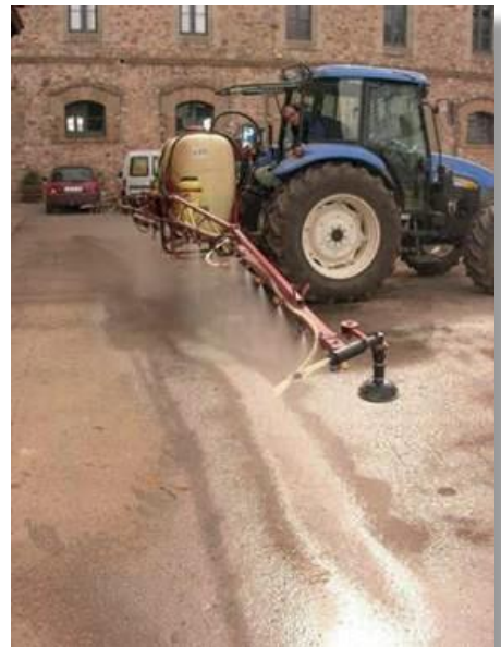
Barra deformada longitudinalmente
