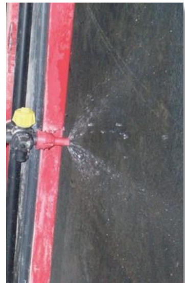
Chorros de pulverización no uniformes
