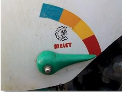
Indicador de nivel correcto y visible desde el punto de conducción y/o desde el punto de llenado
