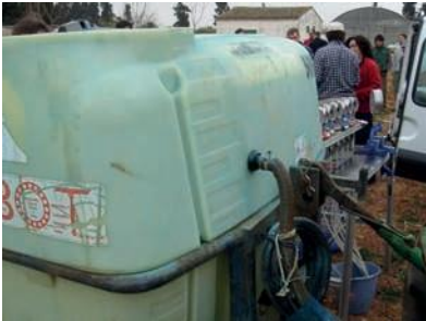
Estado del indicador del nivel defectuoso que impide conocer la cantidad de líquido en el depósito
