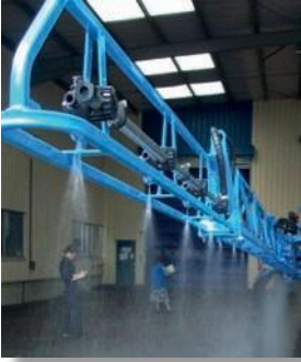
Situación óptima, sin impacto directo del líquido pulverizado sobre elementos de la barra
