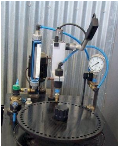
Medida del caudal con las boquillas retiradas de la barra
