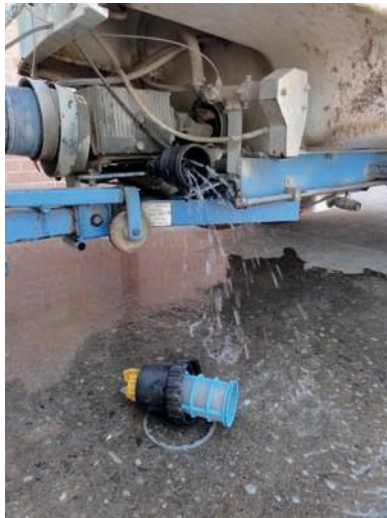
El filtro debe poder abrirse sin riesgo de pérdidas de líquido y sin necesidad de vaciar el depósito
