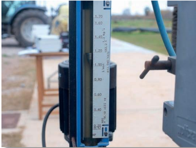
Determinación del caudal, con las boquillas retiradas de la máquina
