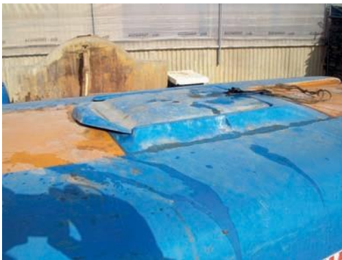
Ausencia de un sistema de compensación de presión en la tapa del depósito
