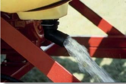
Vaciado correcto con válvula de vaciado del depósito
