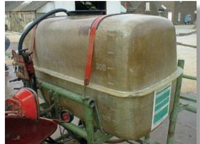
Estado del indicador del nivel defectuoso que impide conocer la cantidad de líquido en el depósito
