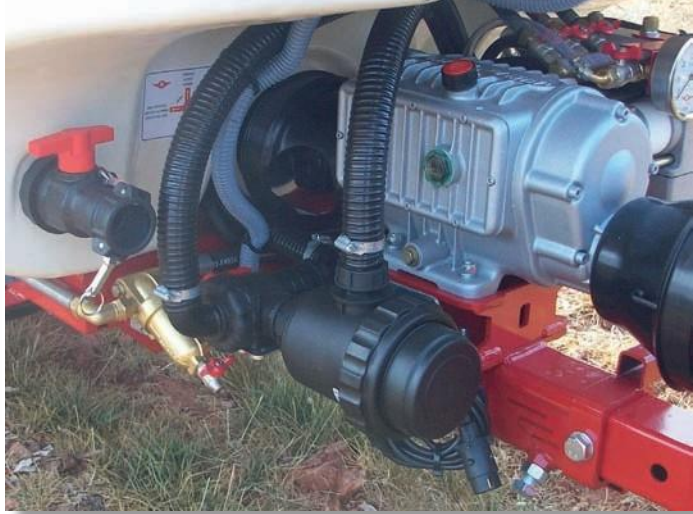
El filtro de aspiración dispone de un dispositivo de aislamiento
