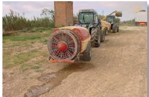
Fugas visibles e importantes en el depósito o en otras partes de la máquina
