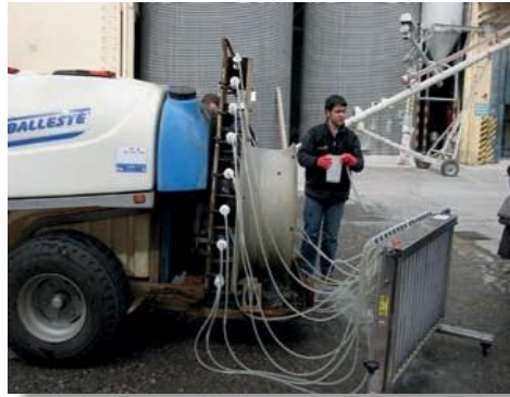
Determinación del caudal con las boquillas instaladas en el pulverizador
