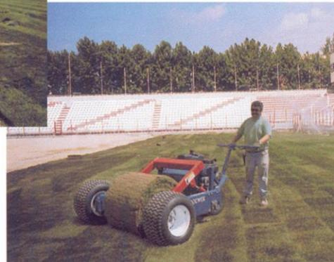
Para el cambio de césped en instalaciones deportivas se utilizan máquinas especializadas que realizan el corte con una cuchilla por debajo del tapiz herbáceo, a la vez que lo enrollan o lo apilan en bloques.
