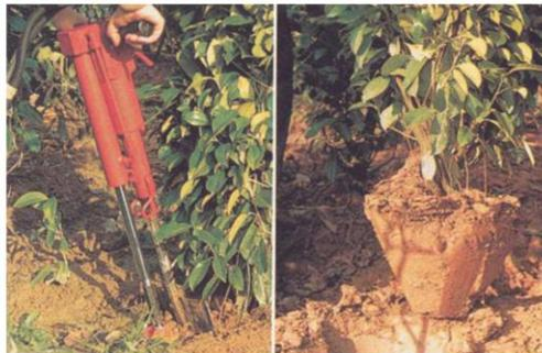
Para el trasplante de árboles se comercializan máquinas especiales que permiten el arranque del árbol mediante hojas cortantes que se clavan en el suelo. La extracción se realiza junto con la tierra que rodean las raíces.
