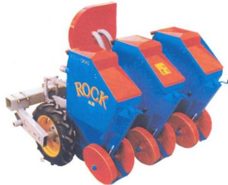
Se comercializan máquinas plantadoras para ajos, que combinan para dosificar un dispositivo de cangilones, similar al de las plantadoras de patata, pero con tamaño adaptado al diente de ajo, con un selector neumático que actúa en dos etapas, en la primera mediante succión y en la segunda mediante presión.
