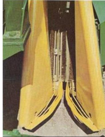
Dos cepillos enfrentados, colocados formando ángulo con la horizontal, giran, en sentidos opuestos y hacia arriba, peinando las matas y provocando el desprendimiento de las cápsulas; con sinfines laterales se elevan hacia una conducción en la que una corriente de aire se encarga de transportarlas hasta la tolva.
