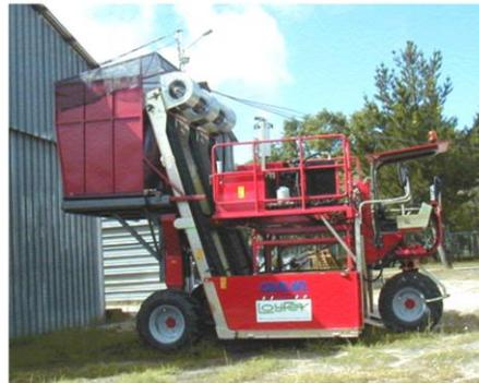
Con independencia de la marca considerada, los principios para la recogida mecanizada de la hoja en los tabacos de tipo Virginia Bright son bastante similares. Estos dispositivos se incorporan a un bastidor autopropulsado de alto despeje (hasta 2.20 m) para poder circular entre las líneas del cultivo.
