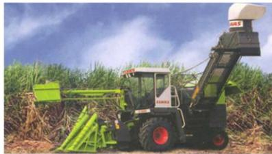
En la actualidad se ha generalizado la utilización de cosechadoras autopropulsadas de caña de azúcar, que realizan el troceado y la limpieza de la caña antes de descargar sobre el camión que la transporta al ingenio.
