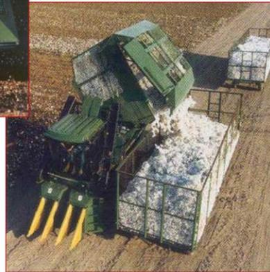
La tolva dispone de unas paredes con perfiles doblados para que no produzcan el corte de la fibra. La descarga puede hacerse por volteo de la tolva o por elevación y desplazamiento del fondo móvil.
