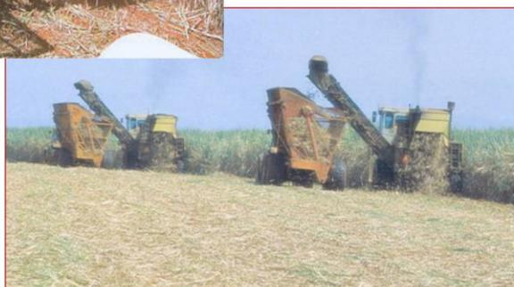
Para las grandes explotaciones se generaliza el empleo de cosechadoras autopropulsadas, mientras que en las pequeñas se recurren a máquinas arrastradas en zonas con nivel de desarrollo más elevado. En ambos casos se procede al troceado de la caña cortada, a la vez que se elimina la parte alta de la caña (ragua) por su bajo contenido en azúcar.
