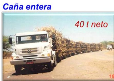
Para el transporte de la caña hasta el ingenio azucarero se utilizan camiones con semi-remolque que arrastran varios remolques. Con caña troceada la caja debe estar cerrada; cuando la caña se transporta entera se admite una caja abierta tipo jaula.
