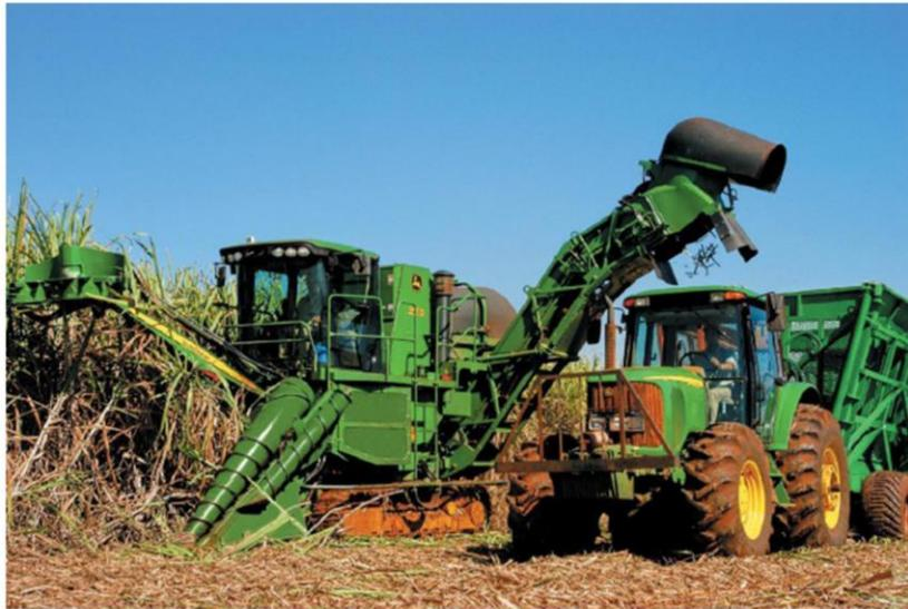
Un punto crítico en las cosechadoras de caña son los elementos de propulsión y guiado. Cuando hay que trabajar en suelos con pendientes de más del 2-4% es preferible utilizar la propulsión mediante cadenas, en alternativa a las ruedas neumáticas. Estas cadenas son similares a las que montan los tractores de cadenas metálicas y soportan en conjunto las 18-20 toneladas del peso de la cosechadora de caña.
