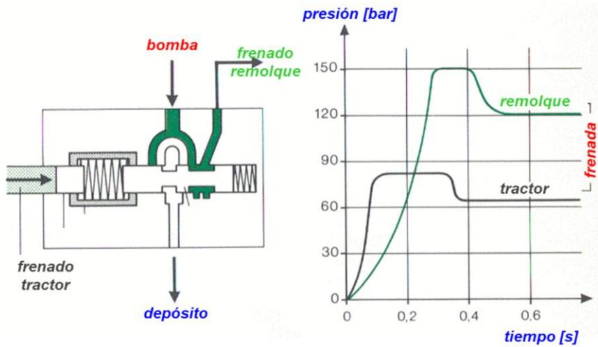
Para el frenado hidráulico servoasistido de los remolques se utilizan válvulas que permiten el frenado progresivo de tractor y remolque.
