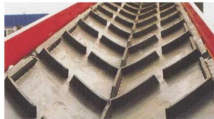
Para materiales delicados, como las patatas, se utilizan transportadores de banda sin-fin fabricadas con caucho u otro material plástico; pueden ser estacionarias o desplazables. Su longitudes varían entre 8 y 15 m, con una velocidad de desplazamiento de la banda entre 0.4 y 0.9 m/s. La potencia necesaria para su accionamiento es inferior a los 2 kW
