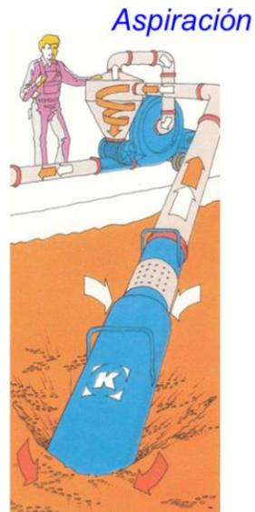
En el transporte de aplicación agrícola se utilizan sistemas de baja presión de aire con elevado caudal.
