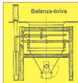
Para recibir el grano que llega a los almacenes se utilizan fosas de recepción en las que se acumula el grano para transportarlo a los secaderos y a los silos de almacenamiento. Para el pesado del material que llega se utilizan puentes báscula (pesada del vehículo) o basculas-tolva.
