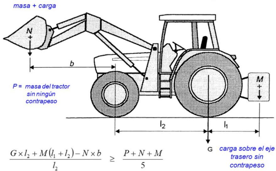
Condiciones de estabilidad según la norma UNE-EN 12525
