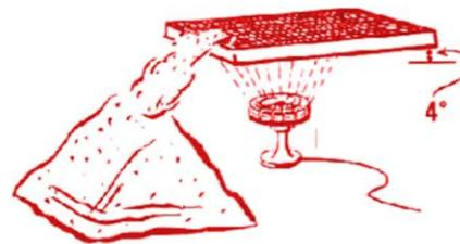
En todo lo relativo al transporte continuo de granos hay que tener en cuenta el talud natural del material, que suele ser de unos 47 grados para los granos agrícolas, por lo que para que pueda moverse sobre un plano inclinado se necesita que éste se incline formando un ángulo entre 47 y 52 grados. Si la superficie es permeable y actúa por debajo de la misma una corriente de aire, el movimiento del grano se consigue con una inclinación de solo 4 grados.
