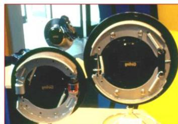
Para los remolques de más de 6 toneladas es necesario disponer de un sistema de frenos propio servoasistido, progresivo y moderable, unido a los frenos del tractor. Esto se consigue con una toma hidráulica específica, que los une al circuito hidráulico de frenos del tractor, definida por la norma ISO 5676. En los remolques de dos ejes las ruedas frenadas son, al menos, las del eje trasero para estabilizar la frenada.
