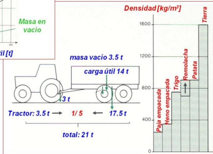
Esquema del conjunto tractor-remolque con referencia a las cargas transferidas para un remolque con 14 t de carga útil, junto con las densidades aparentes de diferentes cargas agrícolas.
