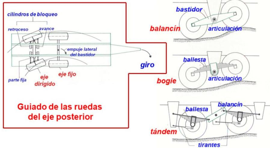
Para facilitar el giro en el caso de ejes dobles o triples, el eje trasero incorpora un sistema de guiado.
