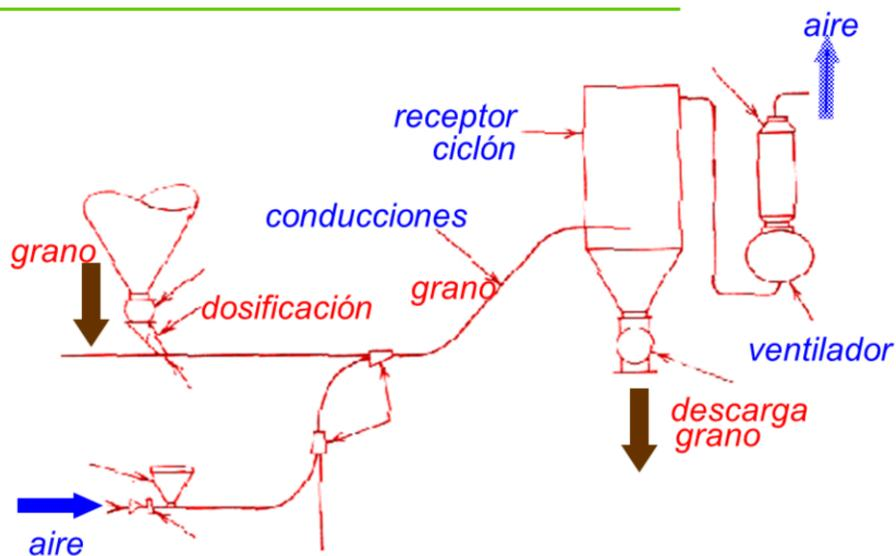
La descarga del grano se realiza mediante receptores (ciclones) que hace perder la velocidad del aire, con lo que el grano cae por gravedad, siendo recogido en la parte inferior del ciclón.
