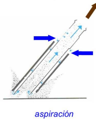
El grano no pasa a través de ventilador, y para realizar la aspiración del grano de un montón se utiliza un sistema de doble tubería cuyo exterior está en contacto con la atmósfera cuando el aspirador se introduce en el montón.
