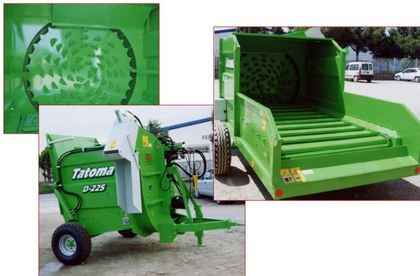
Se pueden establecer diferencias en función de la capacidad de la caja y su adecuación al picado de diferentes materiales. Normalmente son máquinas semi-suspendidas con un solo eje, aunque aquellas que disponen de tolvas de pequeño tamaño también se diseñan como suspendidas para el tripulante del tractor.
