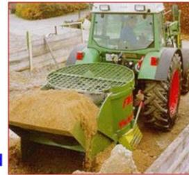
**Triturador-mezclador con sinfín vertical:** La tolva es de forma troncocónica y utiliza sinfín vertical cuyo diámetro disminuye de la parte baja a la parte alta de la caja. En equipos de mayor tamaño se utilizan dos tornillos sinfín verticales y la tolva toma la forma de dos semi-troncos de cono unidos por superficies planas. La longitud de la hélice vertical es un poco menor que la altura de la caja, y dispone de cuchillas en sus bordes que realizan el corte de la fibra larga.
