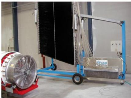
Hay un procedimiento normalizado de ensayo que permite interceptar y “filtrar” el aire impulsado, a diferentes alturas respecto al suelo, y recoger el caldo que transporta en colectores apropiados.
