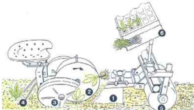
1.- Surcador 2.- Discos 3.- Rueda asentadora 4.- Dedos flexibles 5.- Rodillo delantero 6.- Depósito de planta
