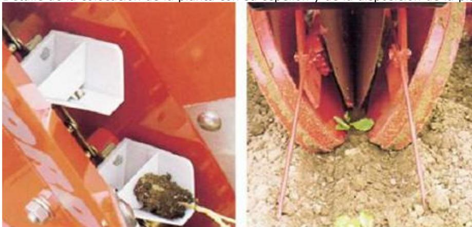
Plantadora de embudo (eje horizontal)
