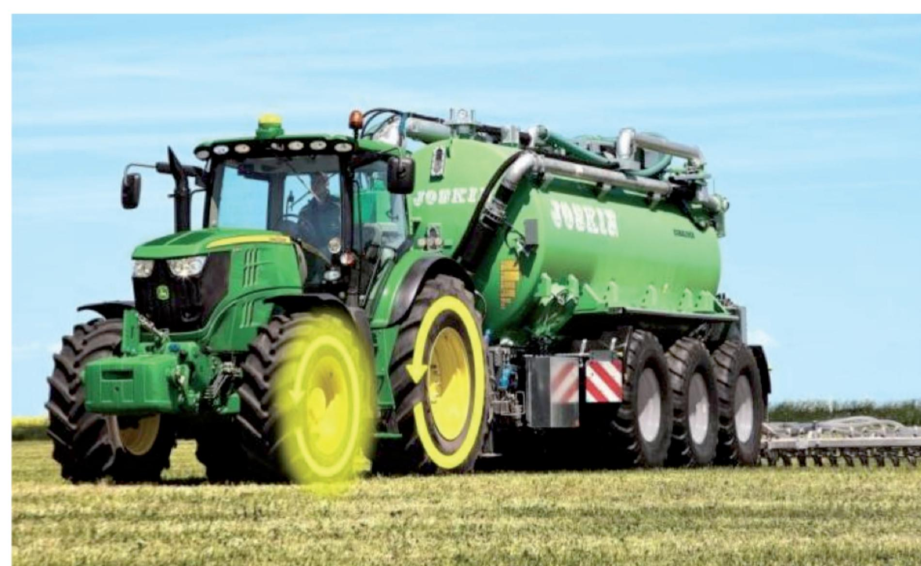
Los sistemas de conexión y desconexión automática de la doble tracción utilizan como referencia la velocidad de avance el vehículo y/o el ángulo de giro de las ruedas directrices. Se utiliza también como referencia el deslizamiento que se produce a partir de la información que suministra el GNSS o el radar, o bien las diferencias de velocidades entre ambos ejes cuando la doble tracción está desconectada.
