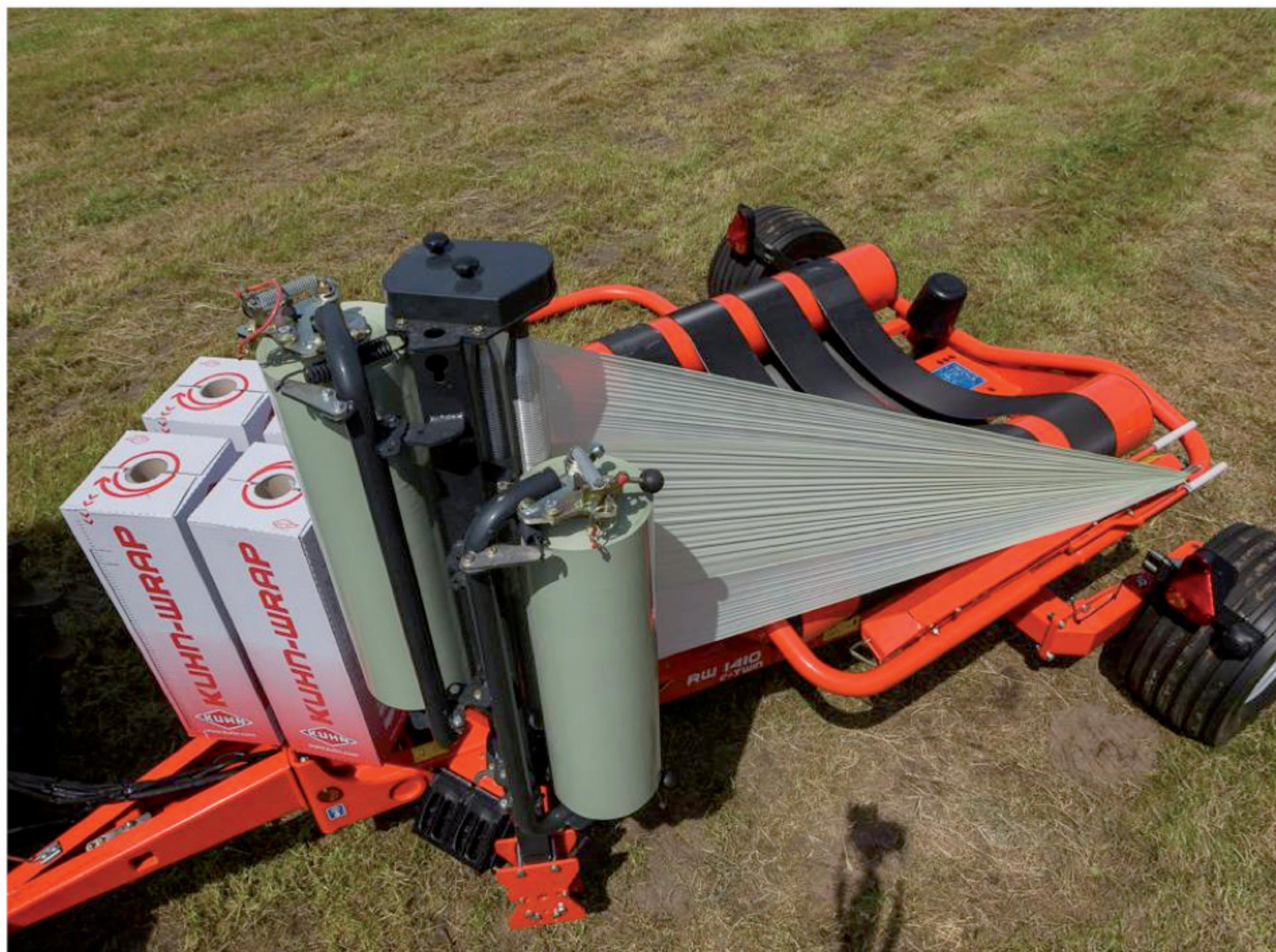
El sistema e-TWIN utiliza dos pretensores cónicos que se posicionan de tal forma que las bobinas de plástico de 750 mm se superponen 2/3. Así, los plásticos de cada bobina se adhieren uno con otro a la salida de los pretensores, creando una capa única de plástico que entra en contacto con la paca.
