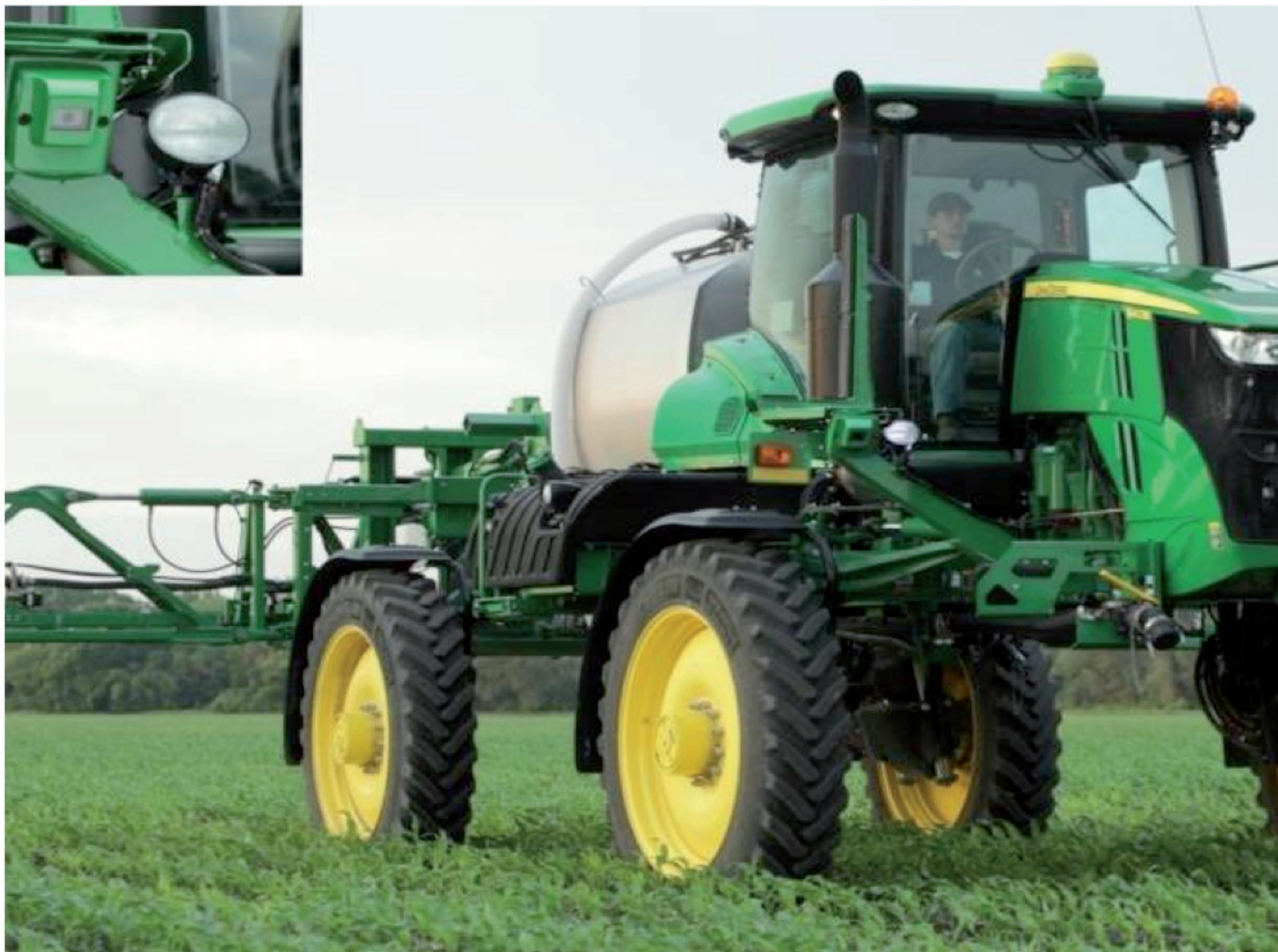
Combina los beneficios de los sistemas GNSS diferenciales con los de sistemas de cámaras que suministran imágenes. Es un sistema de dirección híbrido, que permite conducir a una velocidad de más de 20 km/h en modo de curva y hasta 32 km/h en modo recto.
