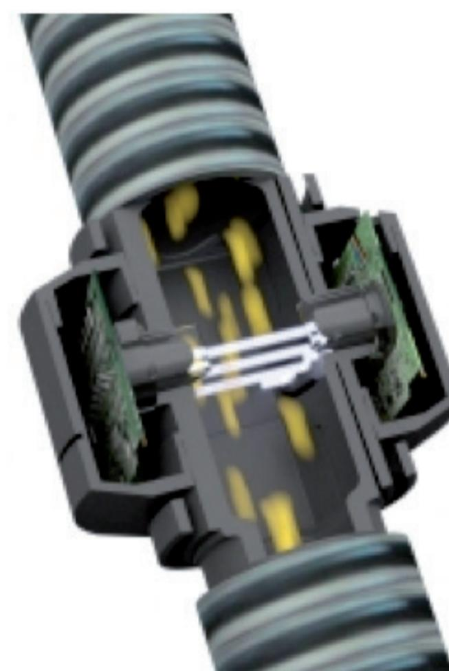
El sistema permite contar el número total de semillas que pasa por la conducción al interrumpir cada una de ellas la luz infrarroja que ilumina el sensor. Permite contar, cuando se utiliza semillas como el trigo, hasta 250 semillas/segundo, con el 99% de precisión, y compensar el polvo y los residuos que se pegan a los sensores.
