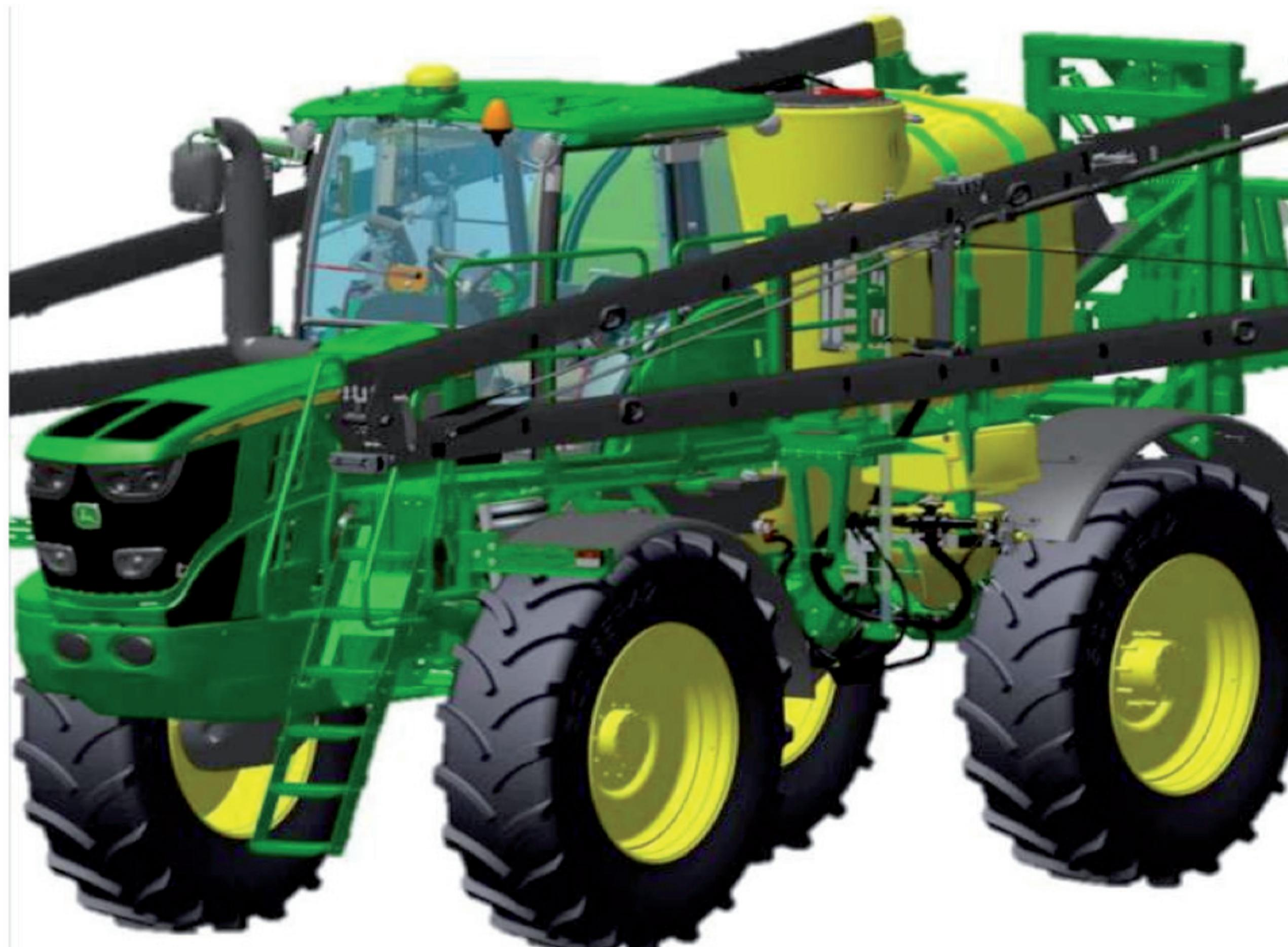
Presenta la combinación de un material ultra ligero y de alta resistencia diseñado con un solo tubo delgado de plástico reforzado con fibra de carbono. Resisten las altas cargas dinámicas sobre un pulverizador autopropulsado usado a altas velocidades de aplicación (20-30 km/h) incluso con bajas temperaturas. Sistema de plegado lateral con una anchura máxima de circulación de 3.00 m.
