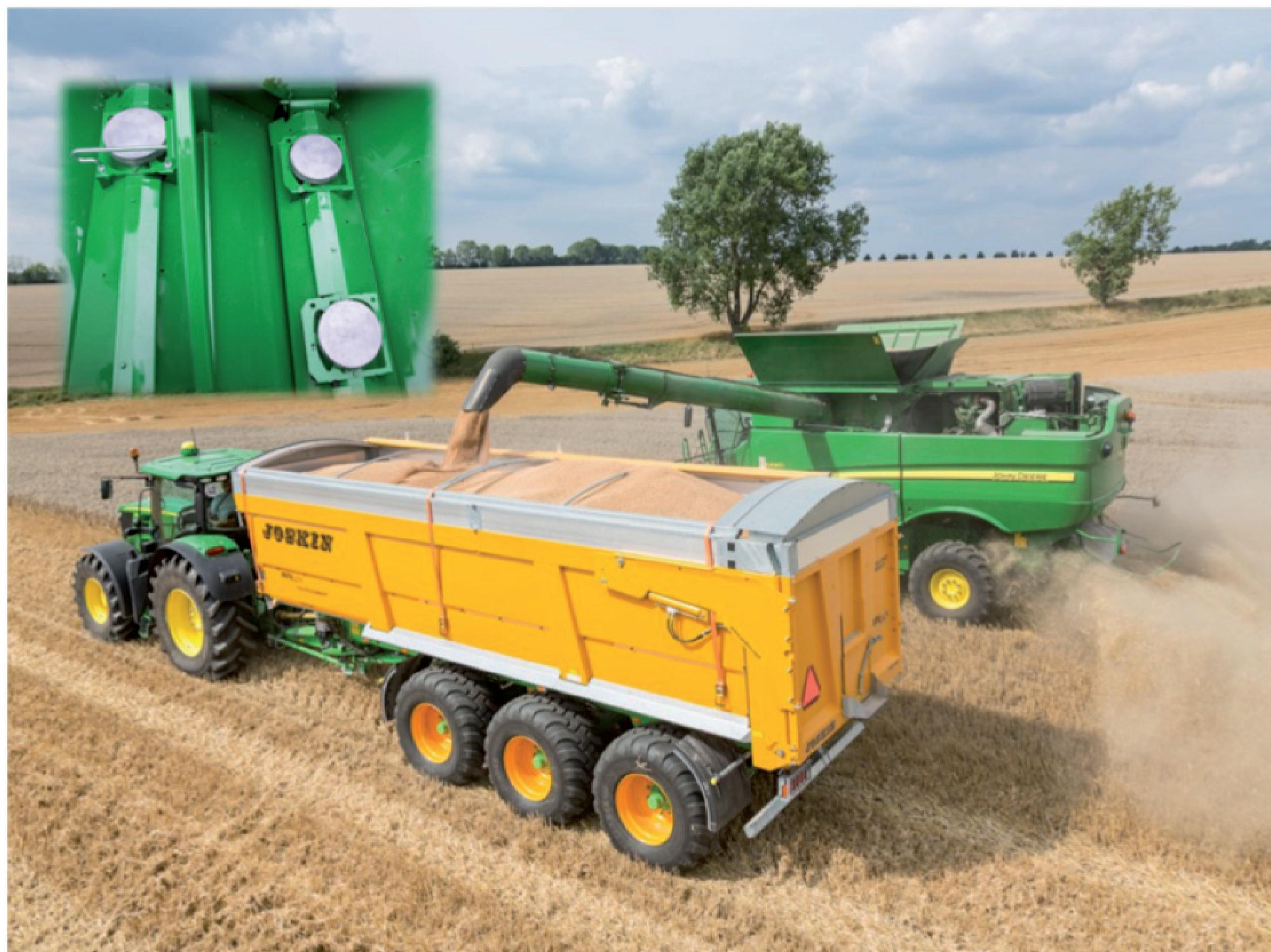
El sistema está dirigido a mejorar precisión de los mapas de rendimiento. Para ello utiliza 3 células de carga en la tolva que miden cargas verticales y determina el caudal de grano que llega al tanque y lo comparan con la información que proporciona el sensor de rendimiento, tomando en consideración la lectura del sensor de humedad. La calibración automática permite que los errores se mantengan en el +/- 3% de la cosecha.
