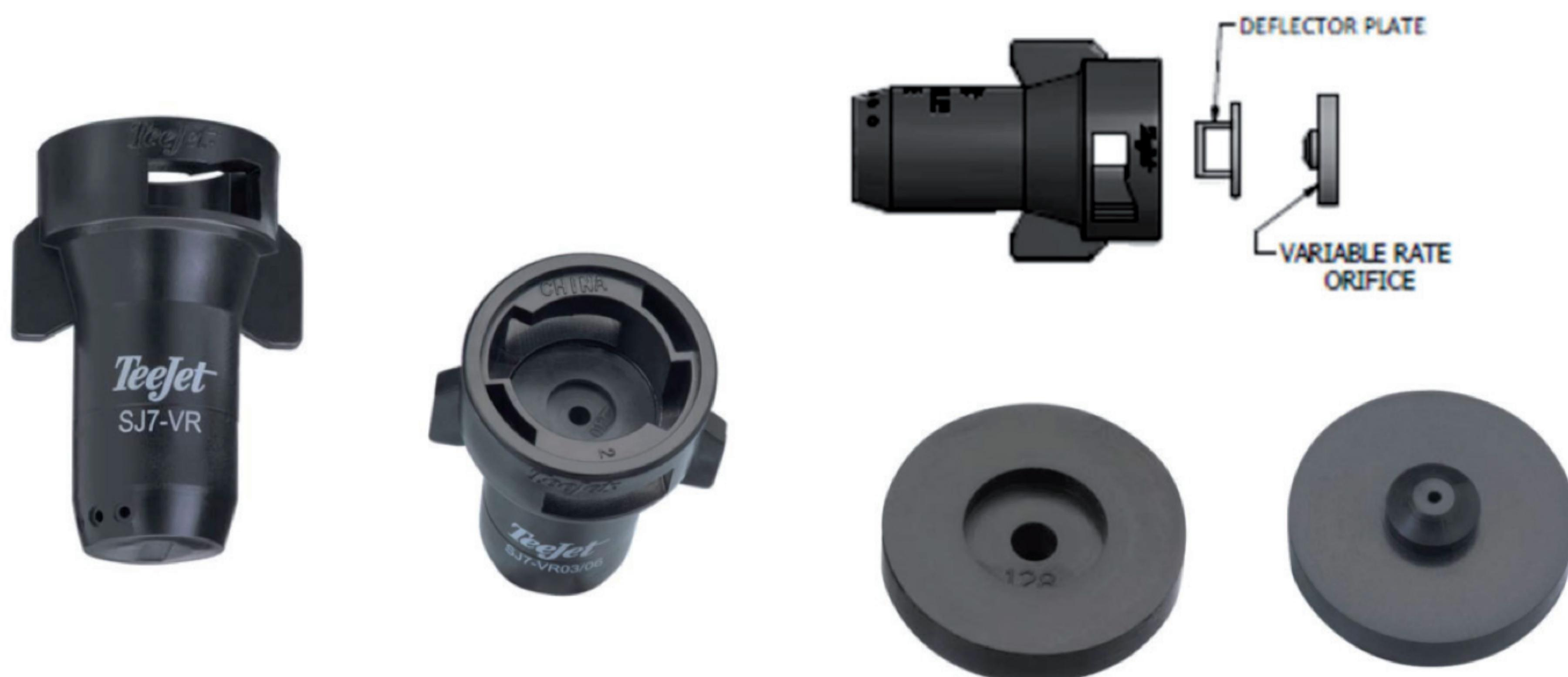
Disponen de un orificio de diámetro variable que produce una amplia gama de velocidades de flujo al modificar las presiones de operación estándar. Esto permite una más amplia gama de velocidades de avance y de dosis de aplicación con la misma boquilla.
