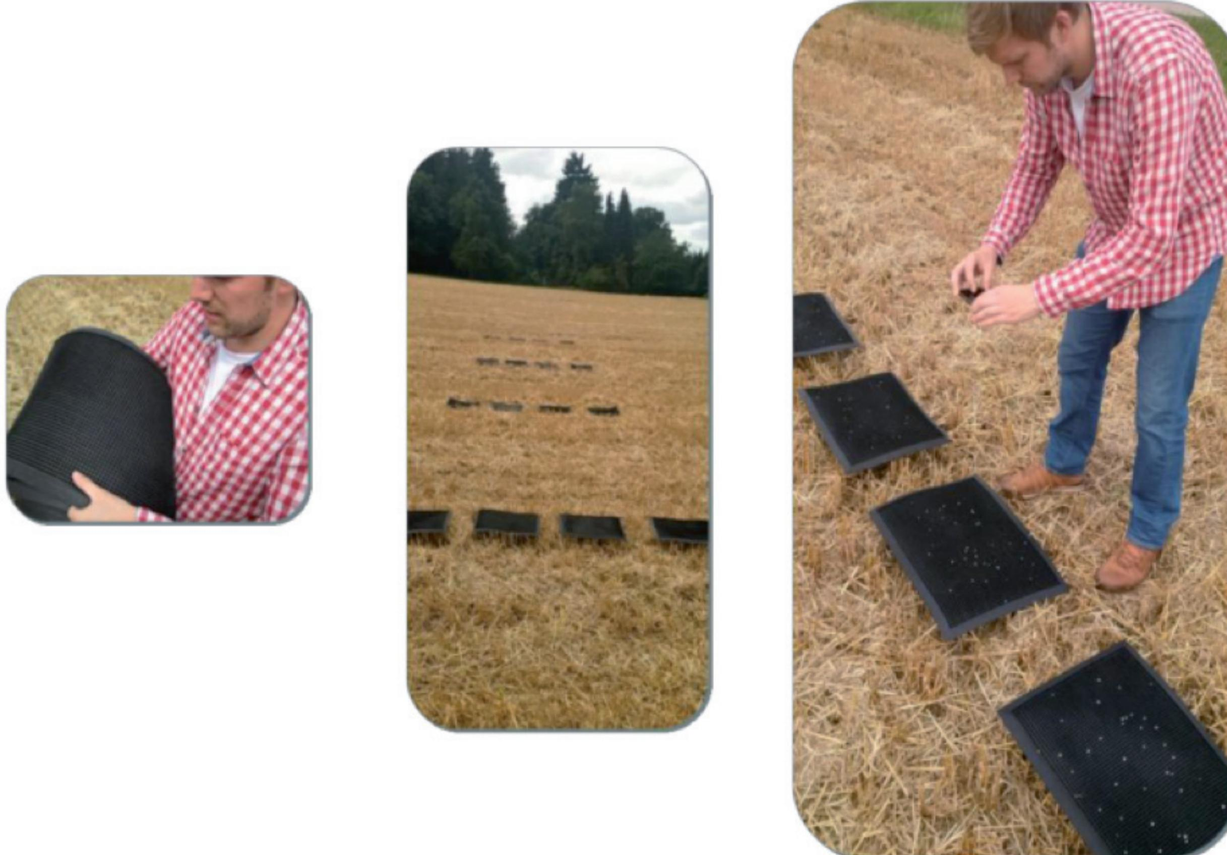
Conjunto de alfombras de bajo peso y reducido tamaño capaces de recoger una muestra del abono esparcido por las abonadoras, que reduce el tiempo necesario para la calibración con bandejas y evita el transporte incómodo de las mismas, lo que hace que sean poco aceptadas por los usuarios. Las alfombras se transportan con facilidad ya que son ligeras y se pueden enrollar y se sitúan en el suelo de forma similar a como se hace con las bandejas.
