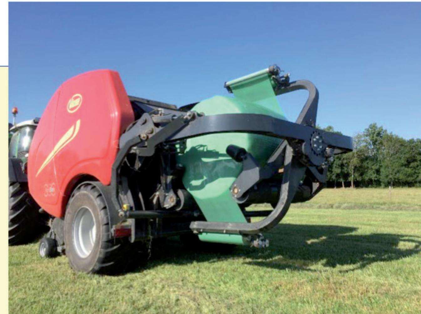
Combina una rotoempacadora de alta capacidad y tamaño reducido con funcionamiento non stop (formación de paca y atado continuos), que puede incrementar la productividad en un 50%, y una encintadora acoplada con un concepto innovador. Dispone de dos cámaras de empacado; una vez llenada la primera cámara (precámara) la paca formada en la misma se transfiere a la segunda cámara (principal) donde se completa la formación de la paca (1.25 m de diámetro) y el atado con red.
