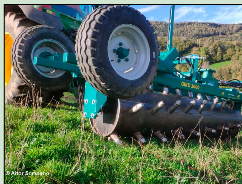
8. Rodillo con tacos para la destrucción de galerías, compactación del terreno e inducción de estrés
