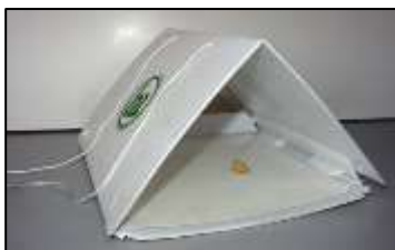
Figura 18: Trampa tipo Jackson o trampa Delta
