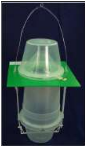
Figura 26: Trampas de embudo modificada (Foto: NIMF 26)
