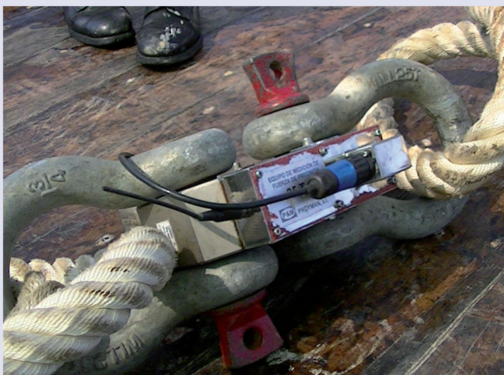
Figura 47. Disposición del dinamómetro a bordo
