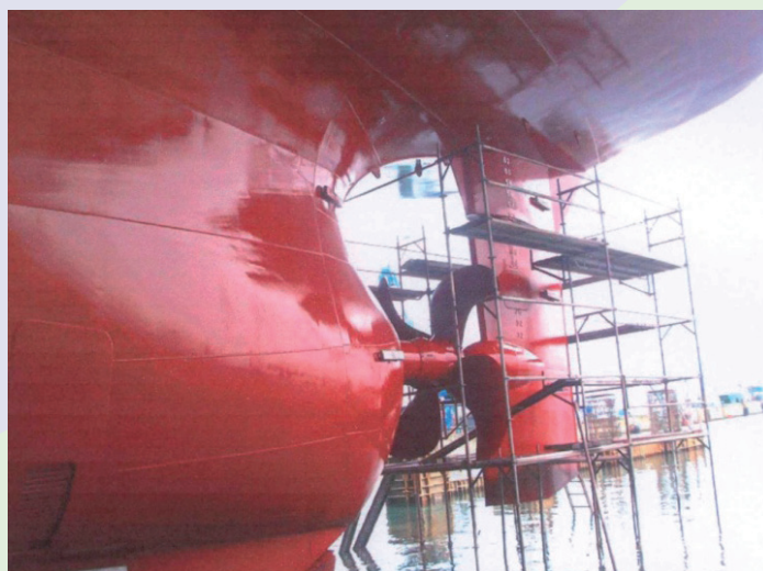
Figura 27. Pintura anti-fouling con siliconas y polímeros de flúor
