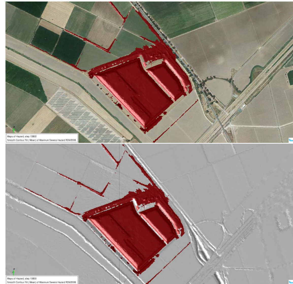
Figura 61. Zonas de graves daños según criterio de RD9/2008 en estado actual
