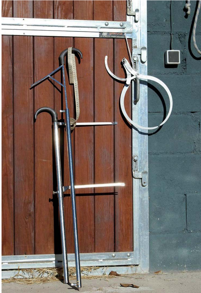
Figura 4. Los 4 instrumentos más habituales en la práctica zoométrica: bastón hipométrico (para ovino el de la izquierda, equidos el central), cinta métrica flexible y compás de brocas. (Foto: autor).
