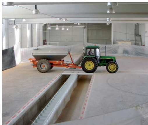
Ensayos de uniformidad de la distribución
