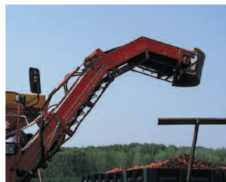
Fig. 6. Elevador para la descarga del tomate.
