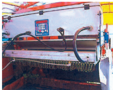
Fig. 4. Detalle del selector electrónico de color.
