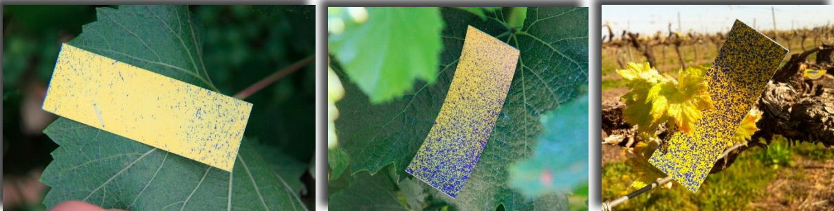
Imagen 16. Papel hidrosensible una vez efectuada la prueba, indicando las gotas impactadas (Santiago Planas)
