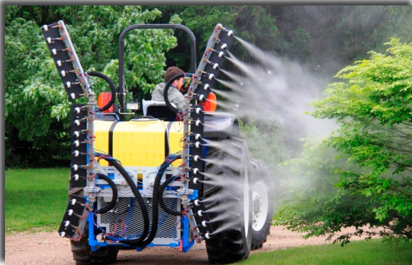
Imagen 11. Pulverizador hidráulico adaptado al tratamiento de formas arbustivas. Obsérvese como la pulverización se encuentra ajustada a la arquitectura del objetivo, minimizando pérdidas y deriva (Santiago Planas)
