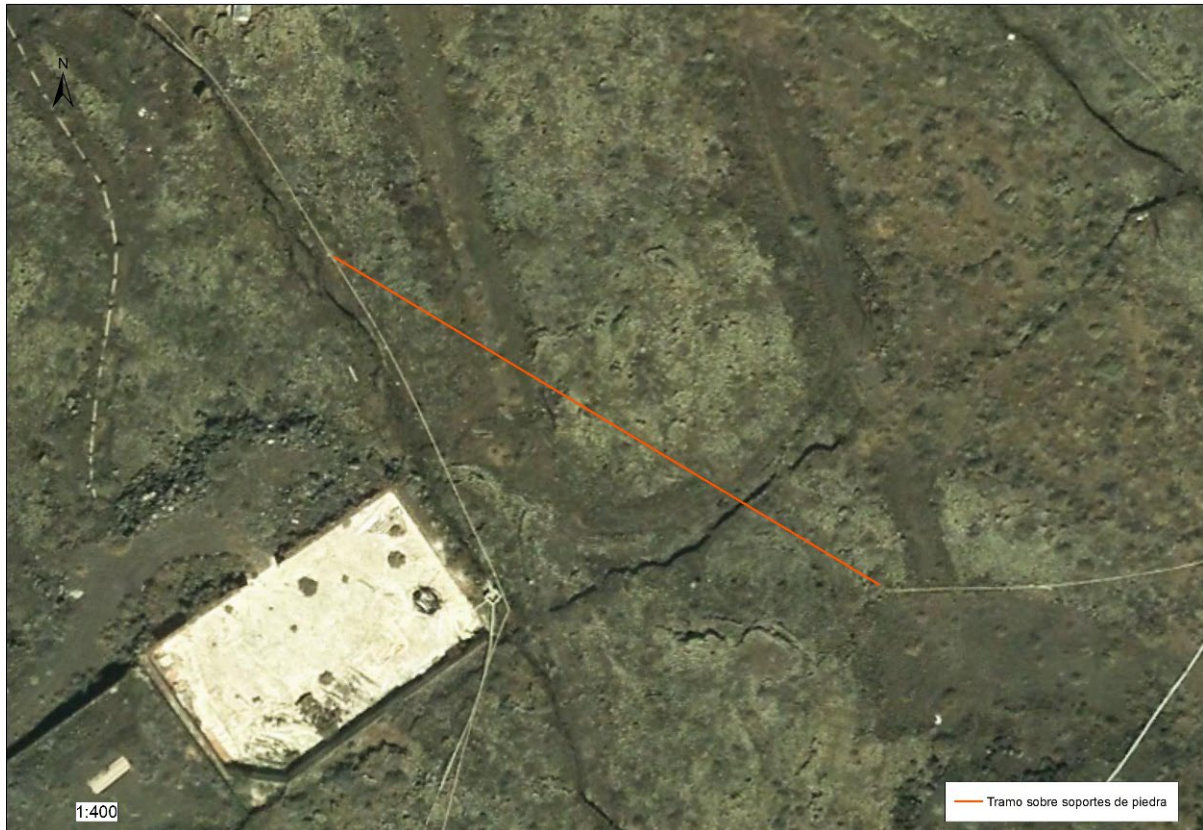
Imagen 103. Tramo a colocar tubería sobre montículos de piedra
