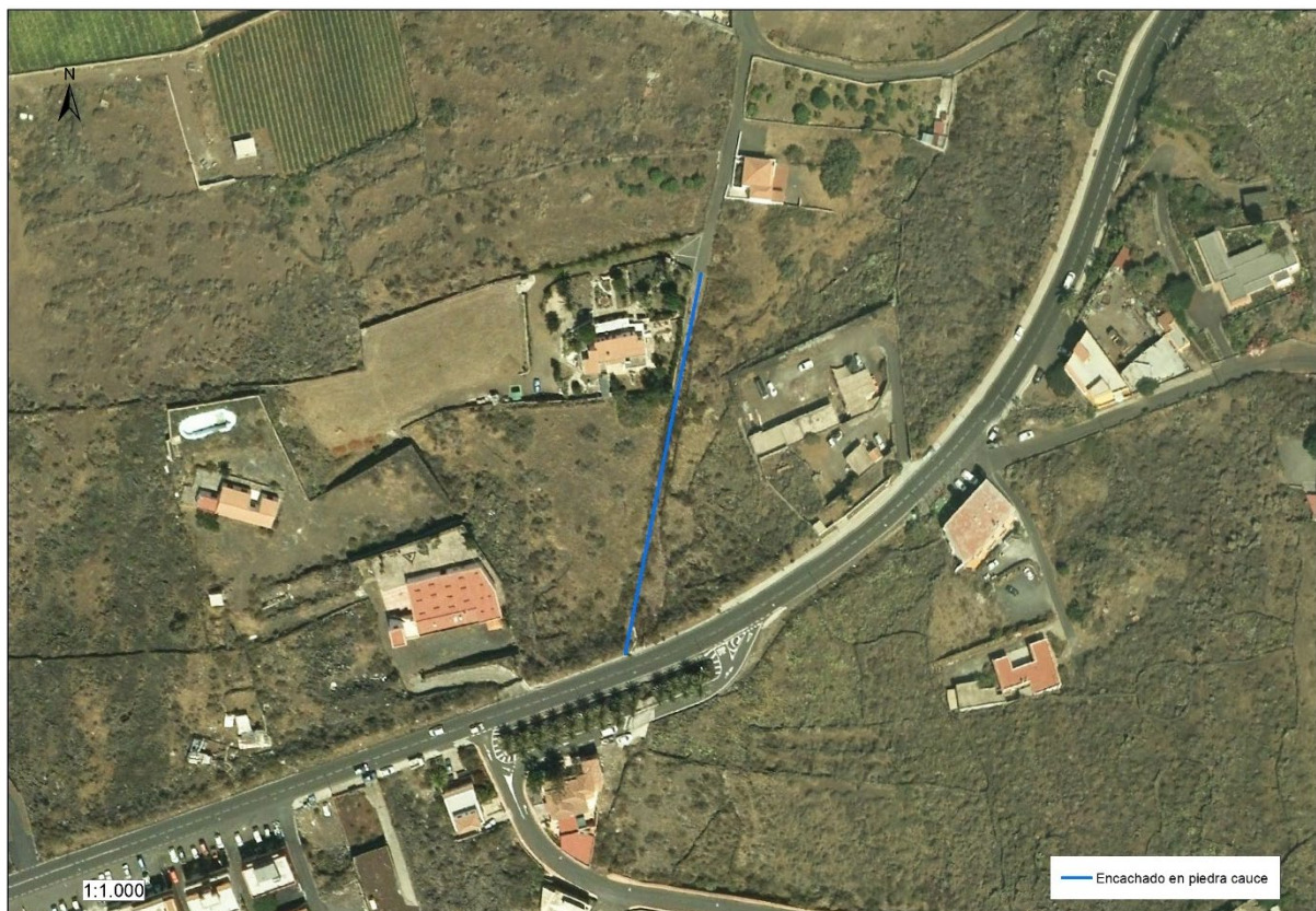
Imagen 98. Encachado en piedra de cauce de barranquera afectado por tubería de impulsión soterrada de las obras accesorias
