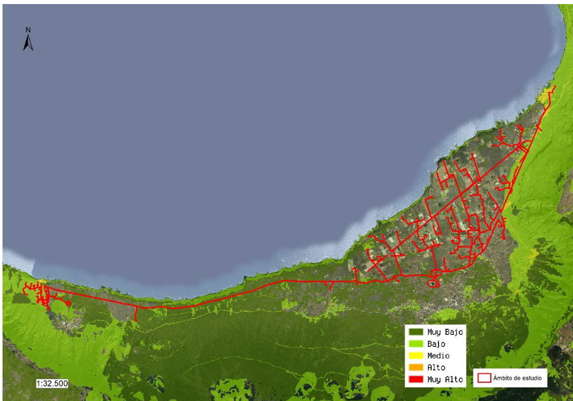
Figura 13. Riesgo de dinámica de laderas. (Fuente Riesgomap)
