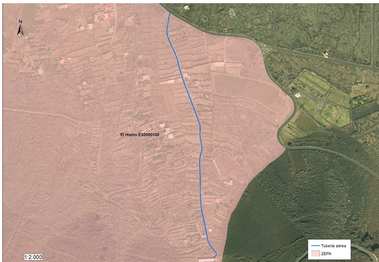
Imagen 56. Trazado de nueva tubería aérea dentro de la ZEPA El Hierro, código ES0000103
