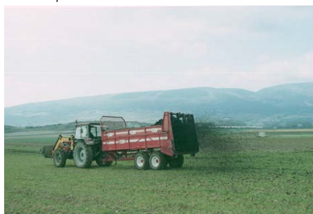
Figura 5. Sistema de aplicación de deyecciones mediante esparcido.
