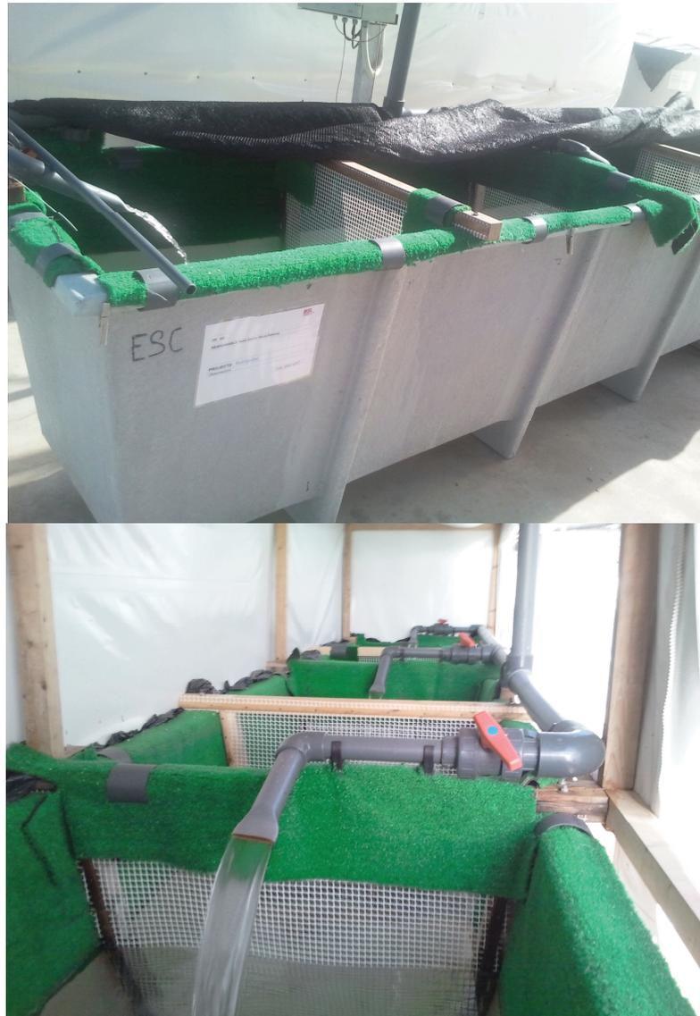
**Fotografía 29. Tanques tabicados en 6 compartimentos (IRTA)**
