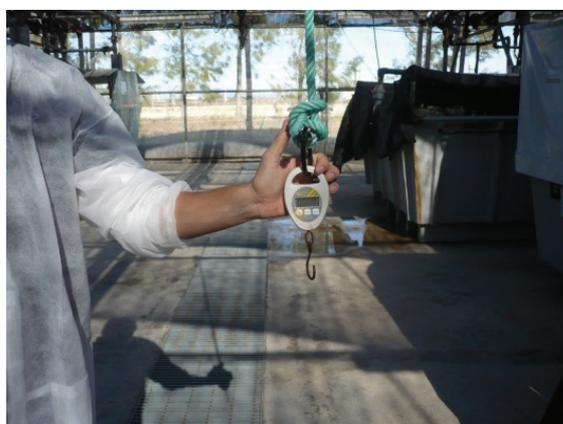
Fotografía 17. Dinamómetro electrónico utilizado para el pesaje.
