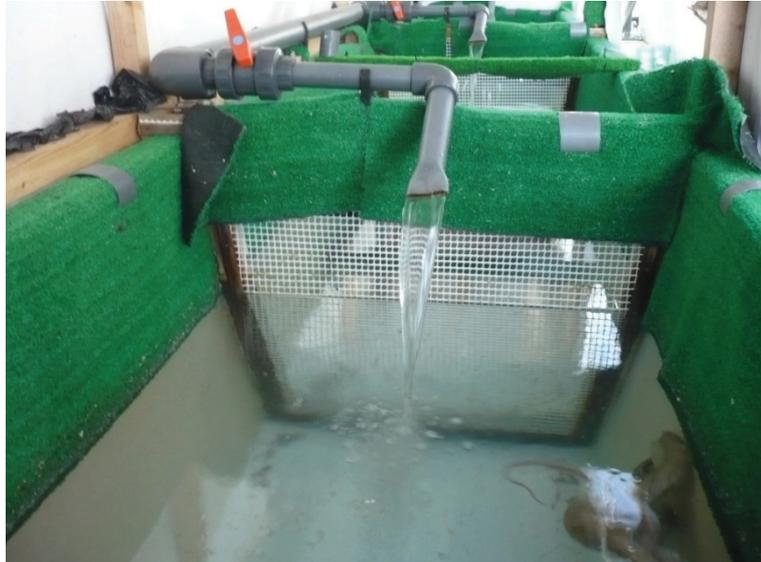
**Fotografía 14. Detalle de la salida del agua de los tanques.**
