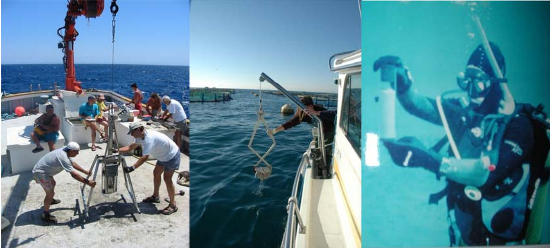
**Foto 1:** Muestréos con draga box-corer, draga Van-Veen y mediante buceo con escafandra autónoma.
